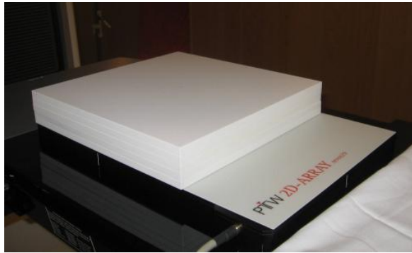
Kuva 6.1 PTW seven29 -ionisaatiokammion annosvasteen lineaarisuuden määrittämisessä käytetty mittausjärjestely.
