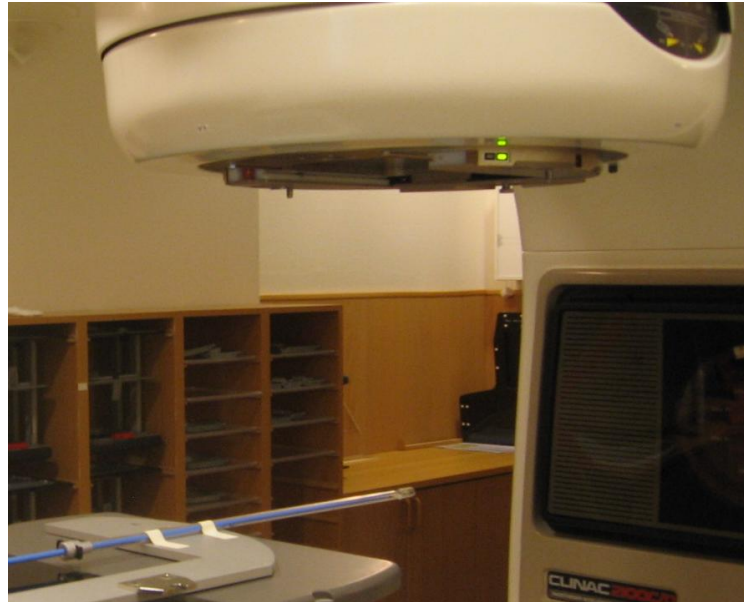
Kuva 6.34 Dosimetrisen raon määrittämisessä käytetty mittausjärjestely. Ohuella kasvupäällyksellä varustettu Farmer-kammio kiinnitettynä vapaasti ilmaan 100 cm etäisyydelle kiihdyttimen säteilyfokuksesta.
