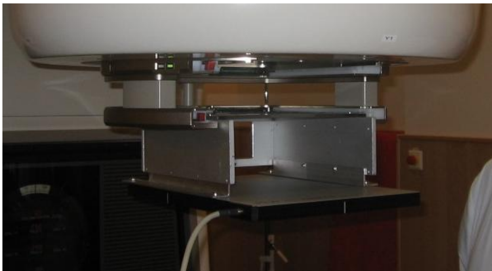
Kuva 6.5 Kanturikulman vaikutuksen tutkimiseen käytetty mittausjärjestely. PTW seven29 -mittalaite kiinnitettynä kiihdyttimen kanturiin tarkoitukseen rakennetulla telineellä.
