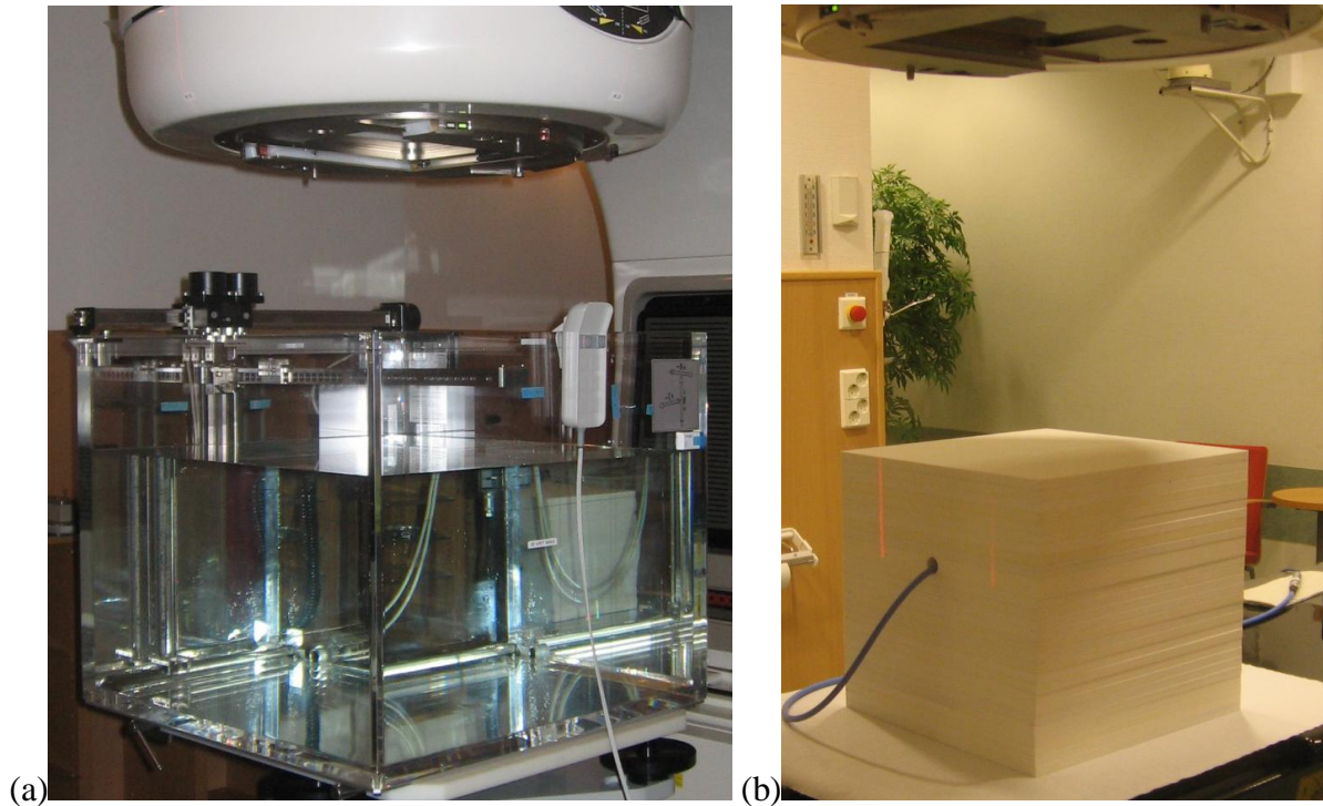
Kuva 6.21 Annosmittaukset (a) vedessä ja (b) kiinteässä vedessä (RW3). Sylinteri-ionisaatiokammio on sijoitettu 10 cm syvyydelle.
