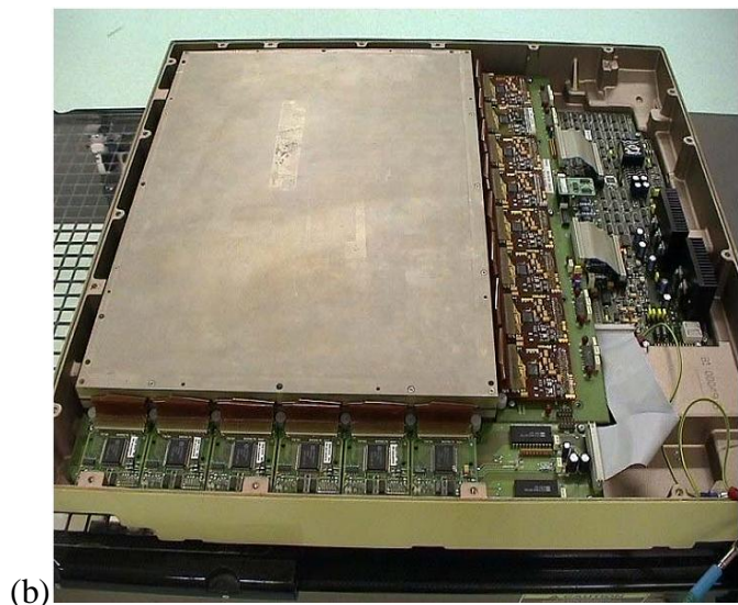
Kuva 5.7 Varian PortalVision aS500 -konekuvauslaite (a) asennettuna kiihdyttimeen ja toimintavalmiina (b) avattuna [11]. Ilmaisinpinnan vieressä on kuvan muodostamiseen tarvittava elektroniikka.
