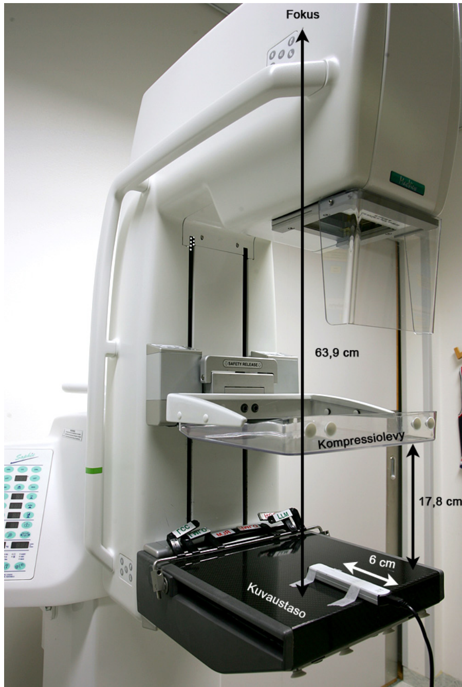
Kuva 4.3. Mittausgeometria säteilytuottomittauksissa sekä pikseliarvoja annoksen funktiona mitattaessa. PMMA-levyt asetettiin mittarin alle testimittauksissa.
