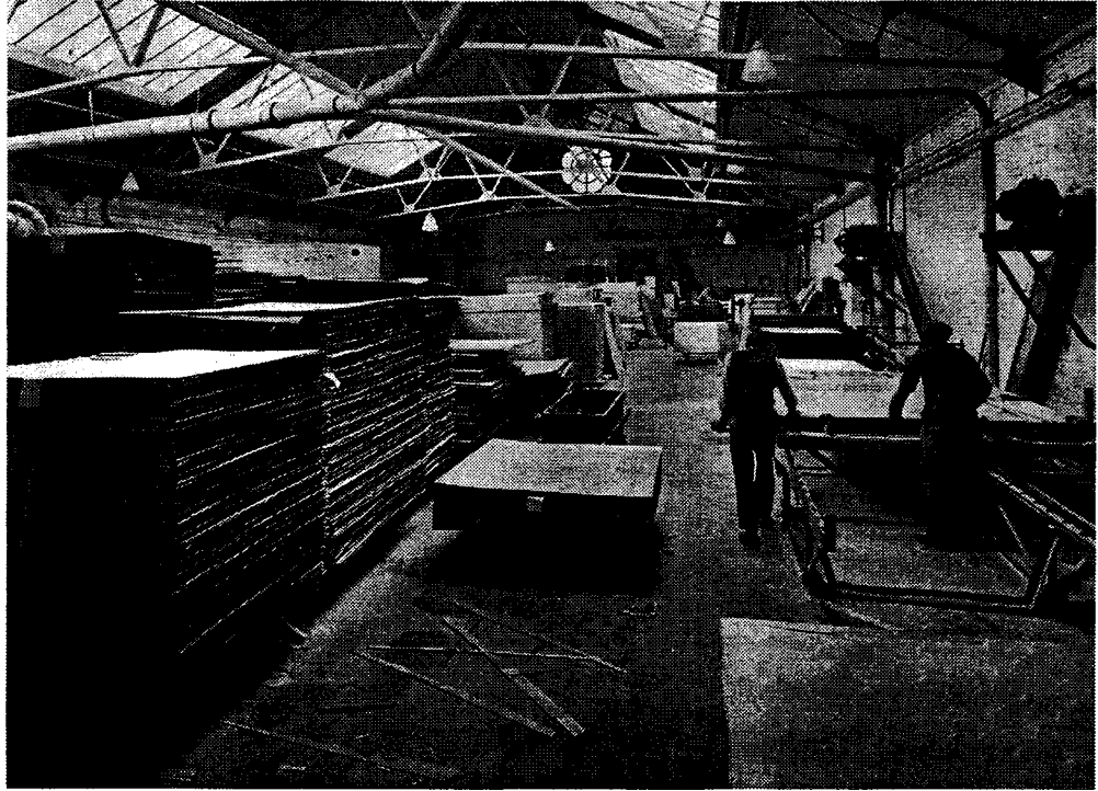
Työteko vaneritehtaalla oli raskasta ja kuluttavaa erityisesti 1900-luvun ensivuosi-kymmeninä. Työpäivät olivat pitkiä ja työturvallisuus puutteellista. Kuvassa vanerilevyjä leikataan määrämittoihin. Kuva Schauman Wood Oy.
