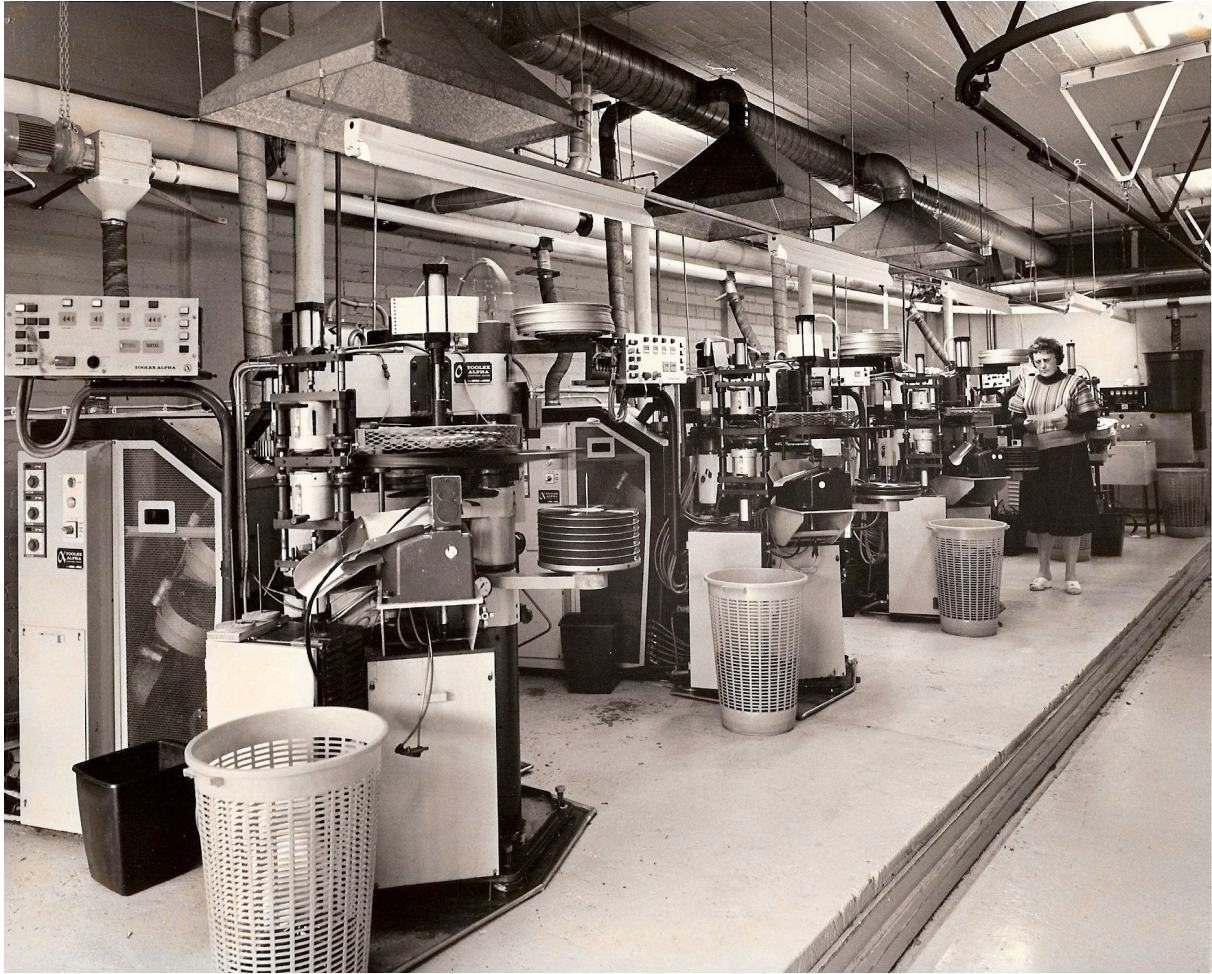
Kuva 7. Osa puristamoa ja Toolex Alpha -täysautomaattiprassejä 1980-luvulta. (© Finnvox Studiot Oy)
