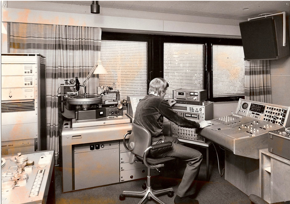
Kuva 6. Kaivertamo ja Pertti Hohtio. Vasemmalla lampun alla Neumann WMS-70-kaiverrin ja oikealla analysaattoreita ja äänenmuokkauslaitteita. (© Finnvox Studiot Oy)
