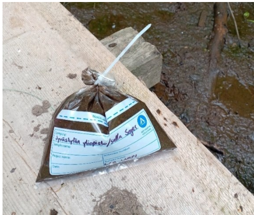
Kuva 7. Maanäytteet otettiin kaasutiiviisiin pusseihin.
