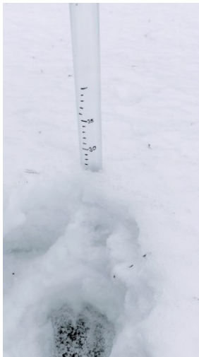
Kuva 5. Luminäytteenottimena käytettiin bailer-noudinta, jonka toinen pää oli leikattu avoimeksi putkeksi.
