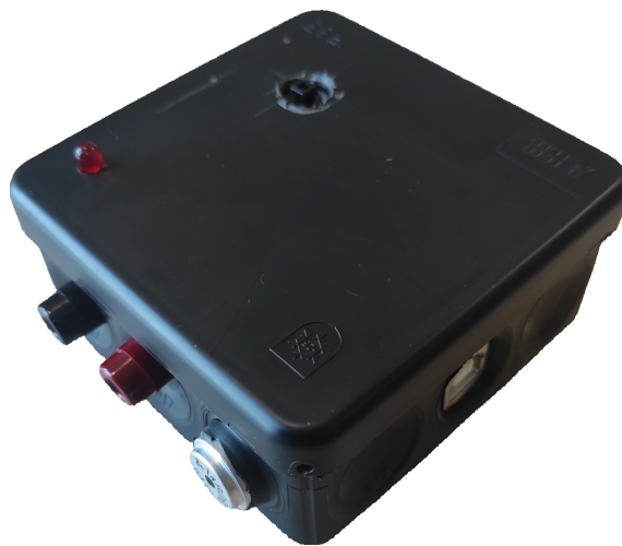
Kuvio 9. Valmis kalibrointilaitteisto kotelossaan, jossa on läpiviennit signaalin ulostulolle (kotelon vasemmassa sivussa) ja virtalähteelle (kotelon oikeassa sivussa).
