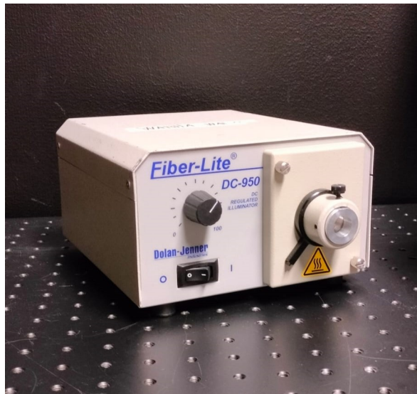
Kuvio 11: Specim IQ-kuvausasetelmassa käytetty halogeenivalonlähde. Valo ohjattiin TLS:n kanssa samanlaista kuitua pitkin rengasvaloon, eli kuvantamisen valaistus oli molemmissa asetelmissa samanlainen
