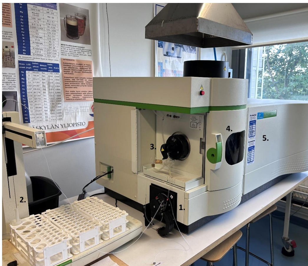
Kuva 15. Mittauksissa käytetty ICP-OES-laite, PerkinElmer Optima 8300. 1. Peristalttinen pumppu. 2. Autosampler. 3. Sumutin sekä sumutinkammio. 4. Plasma. 5. Optiikka.
