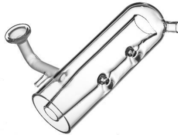
Kuva 22. Scott-sumutinkammio (double pass). 54
