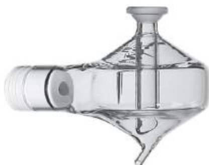
Kuva 21. Sykloninen double pass-sumutinkammio. 52
