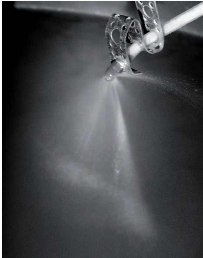
Kuva 6. Kuhan alkukasvatuskokeissa käytetty vesisuihku. Suihkut asennettiin noin 15 cm korkeuteen koealtaiden yläpuolelle puhdistamaan veden pintaa siihen kertyvästä rasvakalvosta. Riittäväksi suihkun virtaamaksi arvioitiin 0,5 l/min. (Kuva: Teemu Jokelainen)
