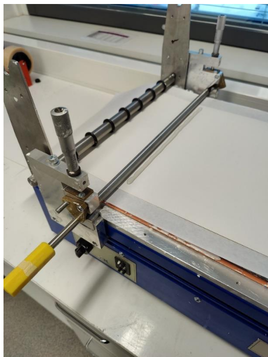
Kuva 22. Näytteiden päällystäminen sauvapäällystyksellä.
