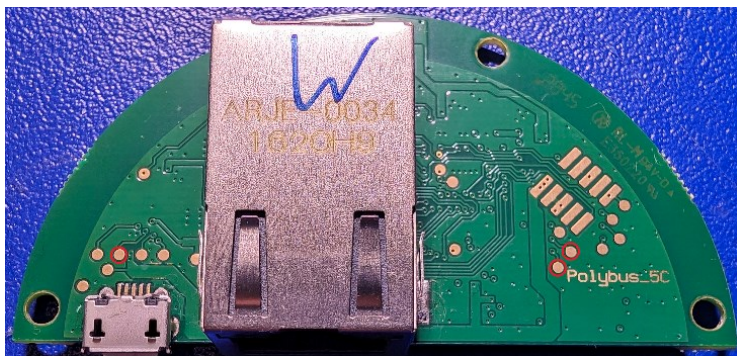
KUVA 22 Laitteen käynnistyessä aktivoituvat testipisteet
