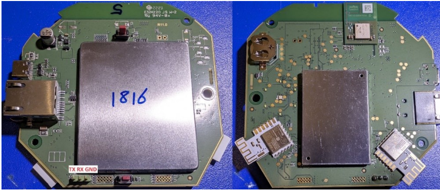
KUVA 25 Dirigera Hubin piirilevyn etu- ja takapuoli
