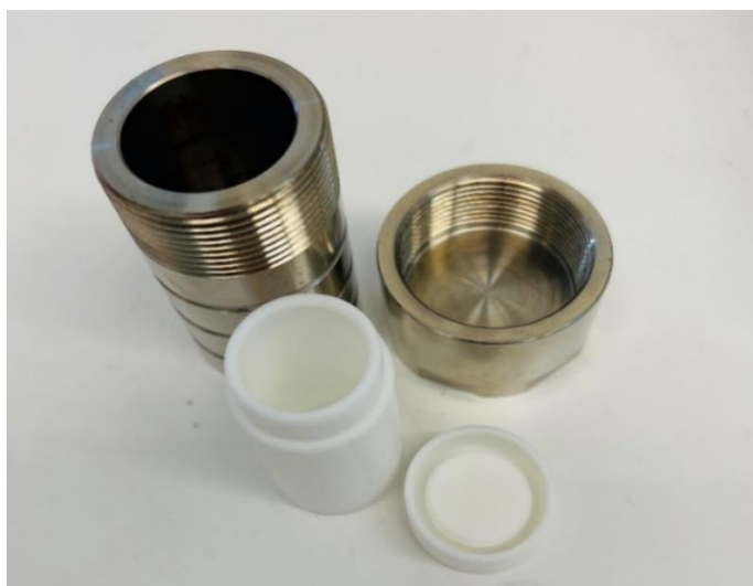
Kuva 6. Metallinen autoklaavi ja teflonista valmistettu sisäästia.
