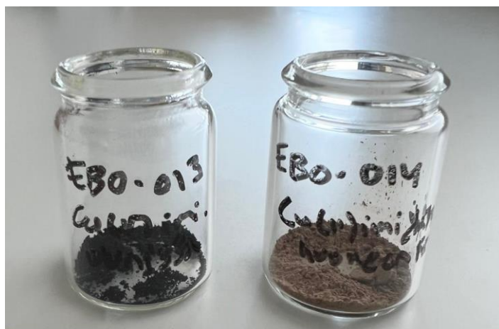
Kuva 13. Syntetisoidut kupari(II)imidatsoliyhdisteet 4 ja 5 . Vasemmalla vihreä modifikaatio 4 , joka syntetisoitiin solvotermisin menetelmin ja oikealla vihreä modifikaatio 5 , joka syntetisoitiin huoneenlämpötilassa sekoittaen. Väriltään vihreää tuotetta ei saavutettu kummassakaan tapauksessa.
