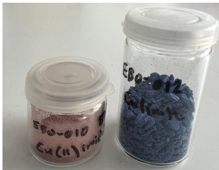
Kuva 12. Syntetisoidut kupari(II)imidatsolaatit 1 ja 3 . Vasemmalla vaaleanpunainen modifikaatio ja oikealla sininen modifikaatio.
