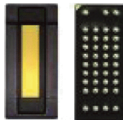
Kuva 5.5: Gaon et al. [26] esittämä silikoninen pyyhkäisy-sormenjälkianturi.
