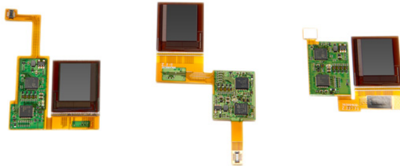
Kuva 5.4: Älypuhelinikäyttöön sopivia NEXT BIOMETRICS NB 2010 S-kosketusantureita [77].
