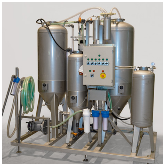
Kuva 12. Preseco SOL10 esteröintilaitteisto, kapasiteetti 160+160 l RME. 45
