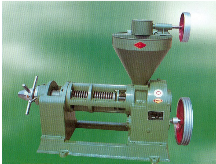
Kuva 9. Pellervo 6YL-95 öljypuristin. 55
