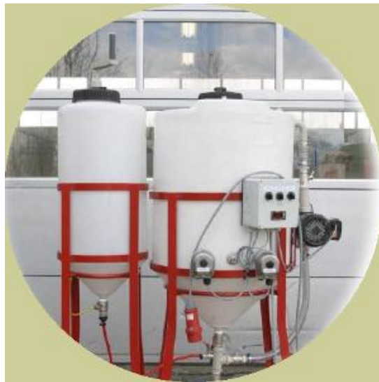
Kuva 11. Biodys C1200 esteröintilaitteisto, kapasiteetti 160 l RME. 56
