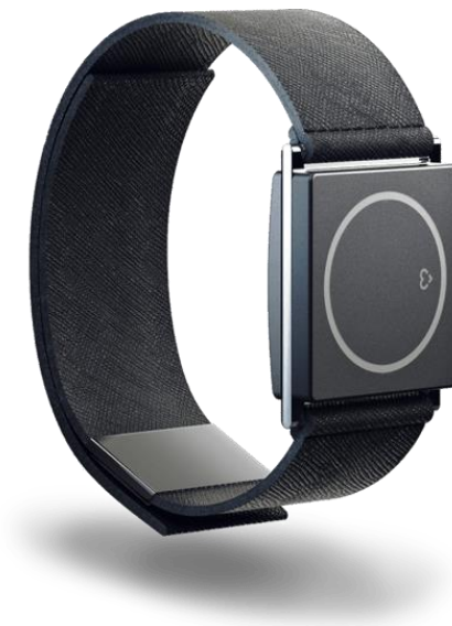
KUVIO 46. Embrace Monitor kohtauksien, unen ja aktiiviteetin mittaamiseen. (Empatica, 2017)
