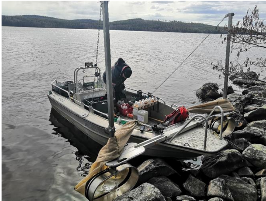
Kuva 1. Veneeseen kiinnitetyt näytteenotossa käytetyt bongohaavit. Kuva Topi Väkevä
