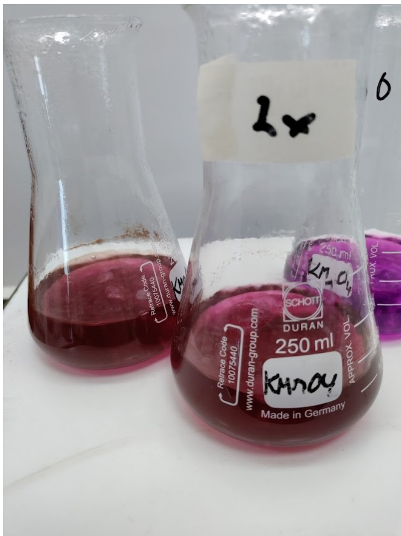
Kuva 1. EKONO-menetelmällä keittoajan lopulla otettu kuva. Kuvassa vasemmalla on VMPK-näyte, keskellä kyseisen VMPK-näytteen kaksinkertainen laimennos ja oikealla MilliQ-vesinäyte. Laimentamattomassa VMPK-näytteessä on muodostunut reilusti mangaanidioksidisakkaa.
