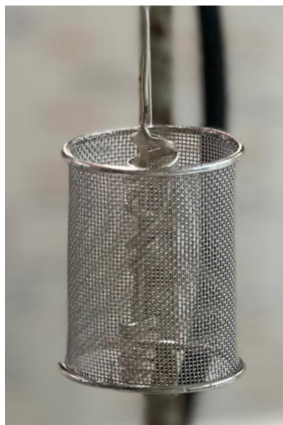
Kuva 39. Elektrolyysissä käytetyt elektrodit
