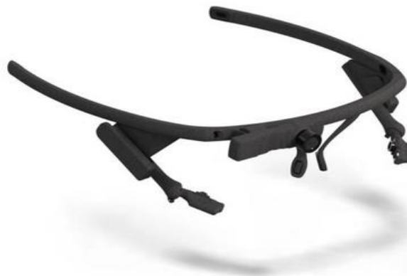
KUVA 2, Pupil Core-silmäliikekamera. (Pupil Labs 2019).
