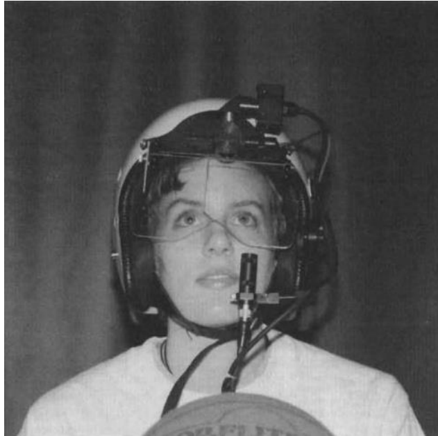
KUVA 1, EVM 3100H-silmänliikekamera. (Vickers 1996, 344)
