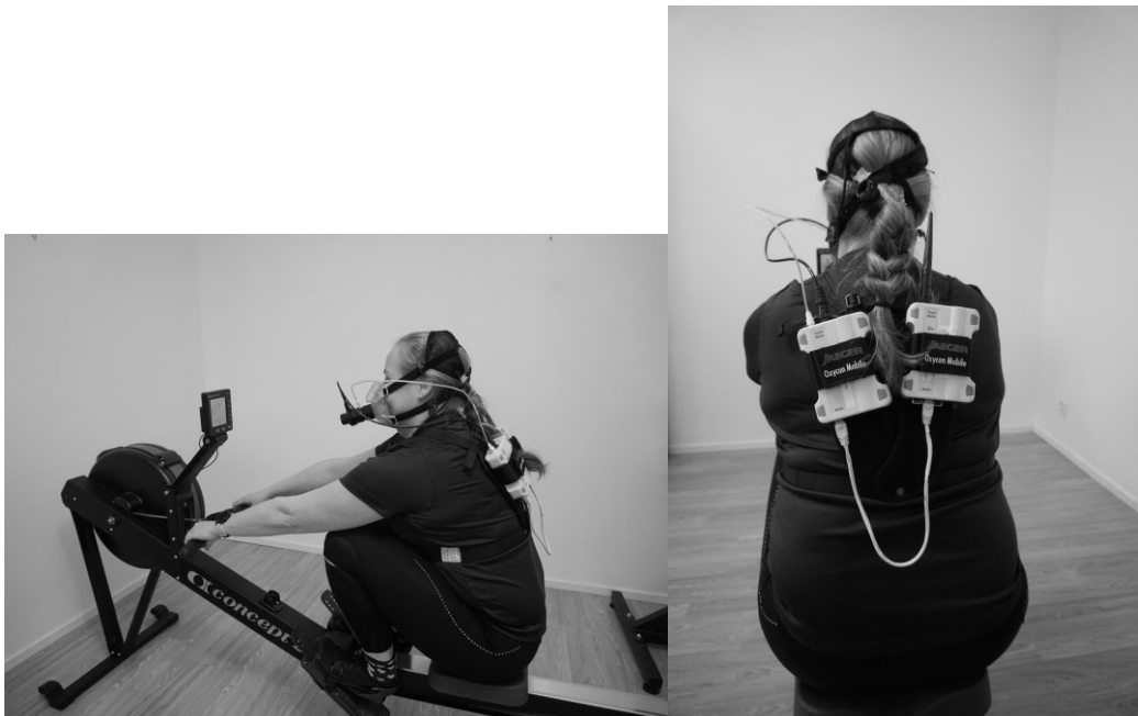
KUVA 6. Soutuergometri ja mittauksissa käytetyn kannettavan hengityskaasuanalysaattorin mittausyksikkö soutajan päälle asetettuna.
