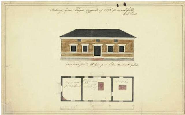
Hämeenlinnassa värjärit olivat keskittyneet pitkälti samalle alueelle. Kuvassa on Carl Sven Lindin rakennuttama värjäämörakennus (1852). Värjäämössä oli kolme huonetta: kuivaushuone, värihuone, josta oli erotettu "plooveri" sinivärjäystä varten sekä oppipoikien asuintila omalla sisäänkäynnillä. Kuva: "Lindin värjäämö," DIGI - Yleisten kirjastojen digitoimaa aineistoa.
