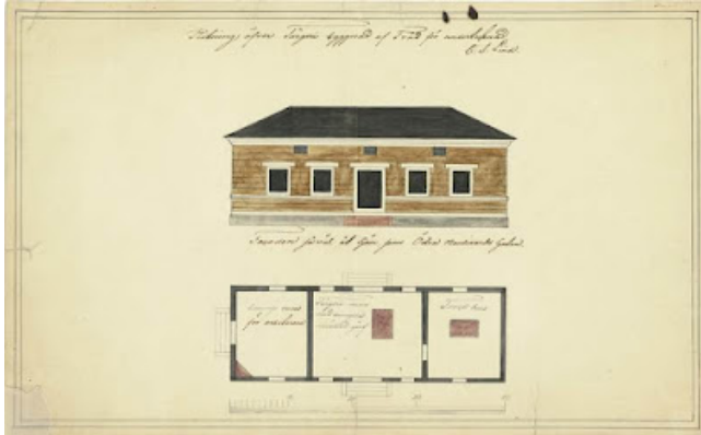
Hämeenlinnassa värjärit olivat keskittyneet pitkälti samalla alueelle. Kuvassa on Carl Sven Lindin rakennuttama värjäämörakennus (1852). Värjäämössä oli kolme huonetta: kuivaushuone, värihuone, josta oli erotettu "plooveri" sinivärjäystä varten sekä oppipoikien asuintila omalla sisäänkäynnillä. Kuva: "Lindin värjäämö," DIGI - Yleisten kirjastojen digitoimaa aineistoa.
