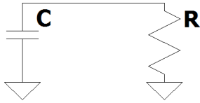
Kuva 11. Oskilloskoopin sisääntulon ekvivalenttipiiri
