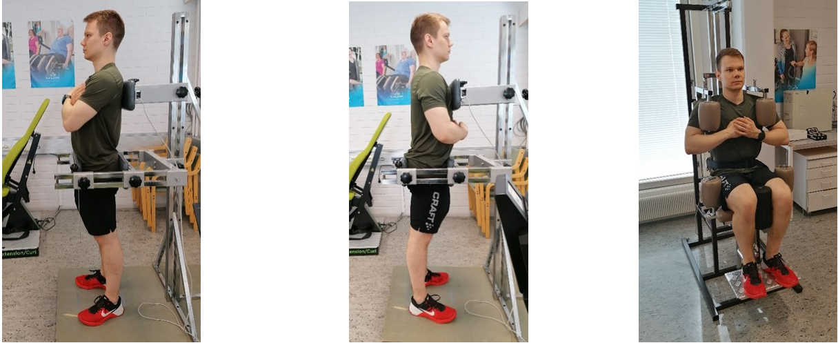
KUVA 2. MVIC:n mittaamiseen käytetyt laitteet ekstensio-, fleksio- ja rotaatiosuuntiin.
