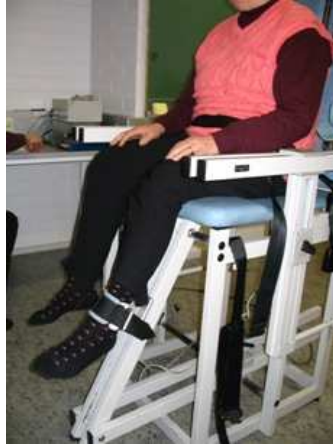
Kuva 3. Alaraajojen maksimaalisen isometrisen polvenojennusvoiman mittaus Metiturin Good strength-laitteella
