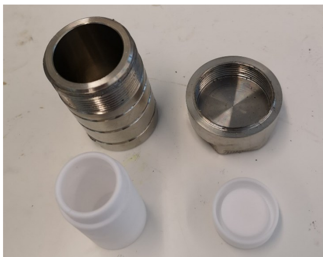
Kuva 14. Solvotermisen synteisin valmistuksessa käytetty autoklaavireaktori ja sen teflonista valmistettu sisäastia.
