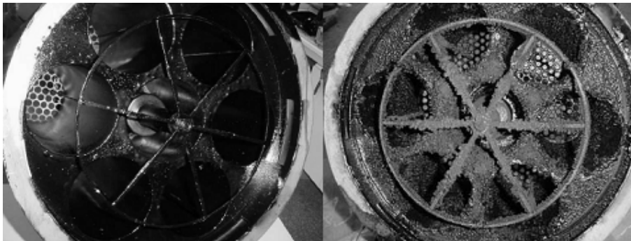
Kuva 32: CleanAir sähkösuotimen sisäkuva ennen ja jälkeen polttotestin
