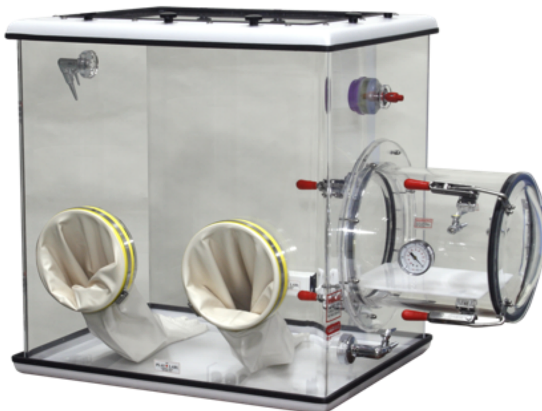
Kuva 19. Valmistajan kuva kokeissa käytetystä Plas-Labsin 830-ABC/EXP hanskakaapista. Kokeissa käytettyyn versioon oli tehty pieniä modifikaatioita, kuten vasemmalle puolelle pieni lasi-ikkuna kokeiden kuvaamista varten, sekä taakse oli tehty johdoille ja antureille läpivientejä. Lisäksi hanskakaappiin oli liitetty kosteudensäädin, jolla kokeissa tarvittavaa ilmankosteutta säädeltiin. (Kuva lainattu viitteestä [32])
