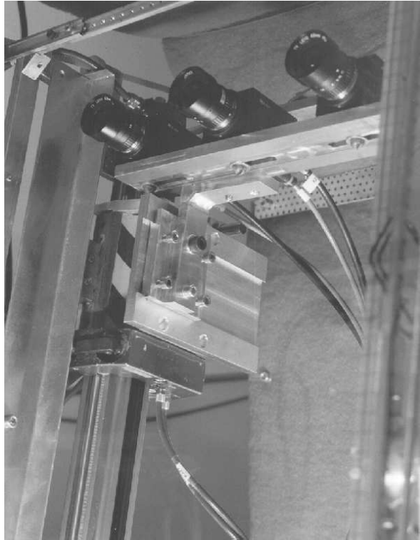
Kuva 15: Kameran liikuttelusysteemi. Kameran on kiinnitetty kelkkaan, jota liikutellaan paineilmasylinterillä.
