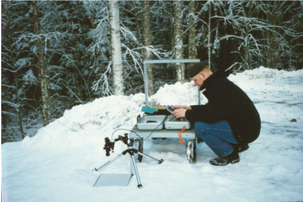
Kuva 4.3 Saapuvan säteilyn mittaaminen heijastusstandardia käyttäen
