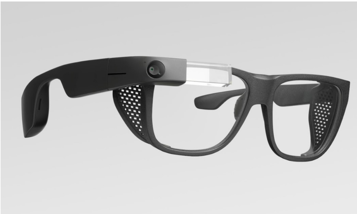
Kuva 13. Google Glass Enterprise Edition 2 -tietokone, joka sisältää HMD:n (Discover Glass Enterprise Edition 2, 2022)
