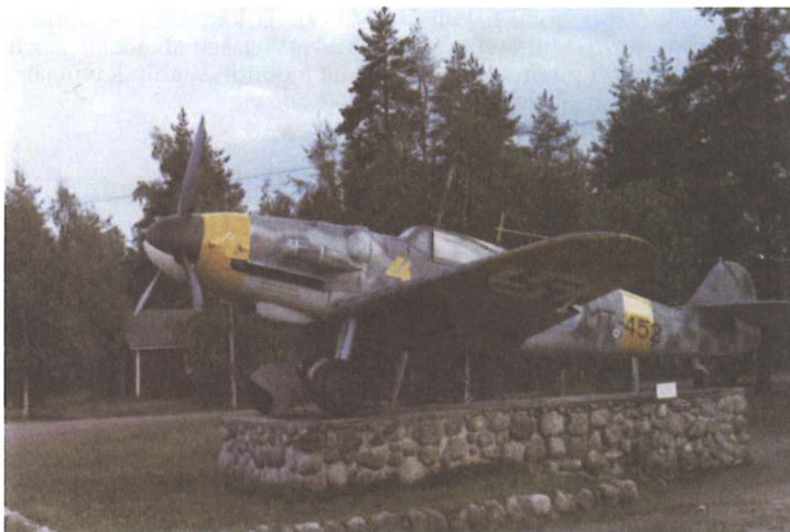
KUVA 3 MT-452 on vapauttanut MT-507:n muistomerkkilineeltä Utissa ja seisoo kaikessa entisöintikomeudessaan kesällä 1971. Ikävä kyllä komeutta kesti vain vajaan vuoden. Huokoinen maalikerros imi vettä, imeytynyt vesi jäätty ja maalaus rapisi jo seuraavana keväänä. Myöhemmät toimenpiteet ja esitykset ovat johtaneet siihen, että kone on nykyisin suljettu lasiseinäiseen vitriiniin, jossa on kosteudenpoisto ja kivijalusta on purettu.
