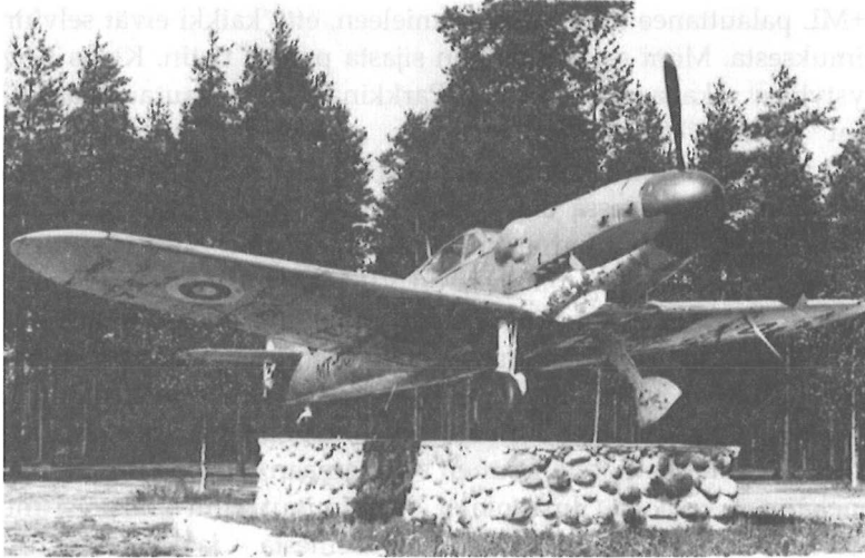
KUVA 22 Muistomerkkikoneen tavanomainen kohtalo taivasalla – rapistumisen merkit näkyvissä ja huonoa on, että ne eivät rajoitu vain koneen ulkokuoreen. Sisälläkin kosteus on päässyt jylläämään. MT-507:n moottoripteitteessä ei ollut alun perin pientä kuumua ja ilmanottoaukkoa 13 mm:n konekiväärin vaatiman kuumun juuressa. Ne ovat tulleet silloin, kun moottoripteite otettiin koneesta MT-512.
