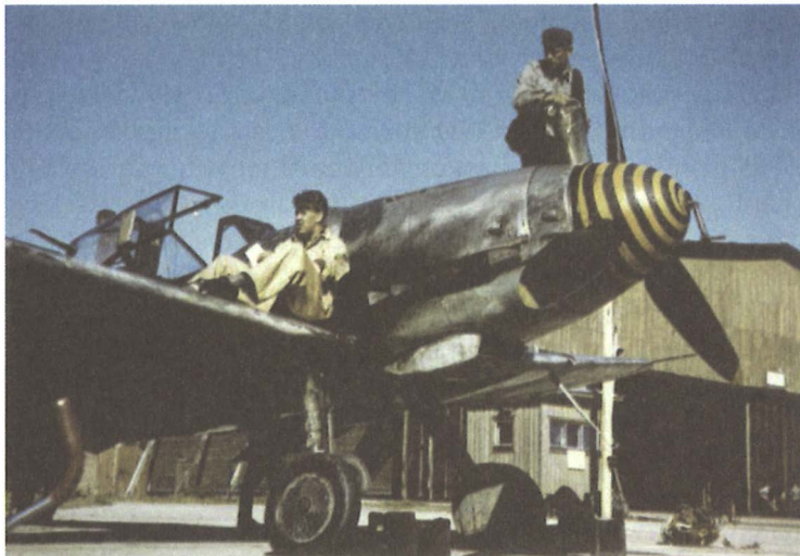
KUVA 17 Hävittäjälentolaivue 33:n lentueenpäällikkö yliluutnantti Matti Wikman odottaa Utissa vuonna 1953 seuraavalle lennolle lähtöä MT-507:n siivellä ja kersantti Pentti Napari on lisäilemässä moottoriin öljyä. Tässä vaiheessa potkurin napakoneiston suojus on ilmeisesti kannibalisoitu jostain toisesta koneesta. Aikaisempi oli musta-valkoinen leveämmin raidoin. Inertiakäynnistimen kampi on sijoitettu tykin lieskaputken suulle veivausta odottamaan.
