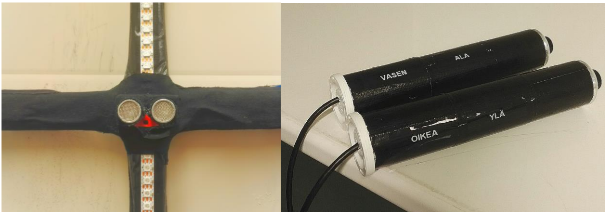
KUVA 4. Vasemmalla kuvassa näkyy laitteen kiintopisteenä toiminut punaisen kolmion keskellä oleva musta piste. Oikealla kuvassa näkyvät ohjainkapulat.
