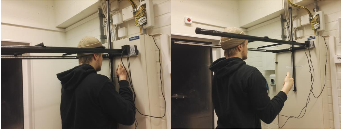
KUVA 3. Mittauslaite. Vasemmalla kuvassa on esitettyä näkökentän vertikaalisen ja oikealla horisontaalisen laajuuden testin asetelma.
