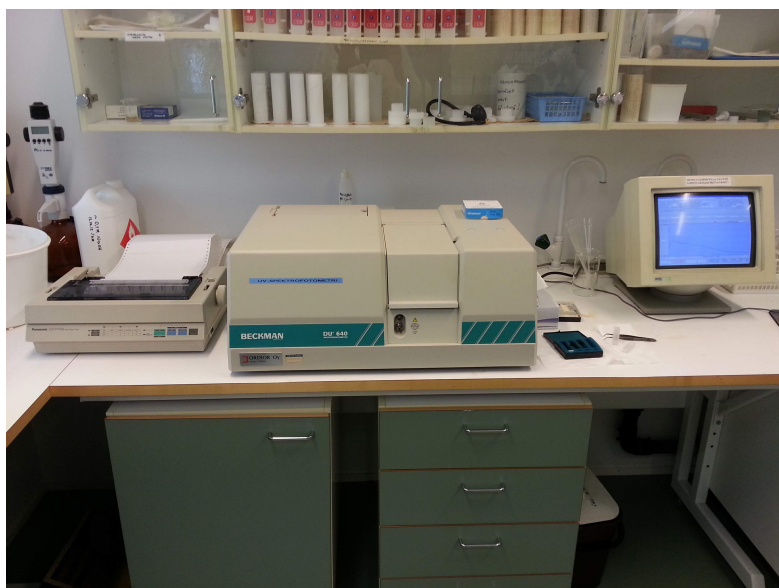
Kuva B.1: Jakautumismittauksissa käytetty Beckman DU 540 UV-spektrofotometri. (Kuva: Esa Rynnänen.)
