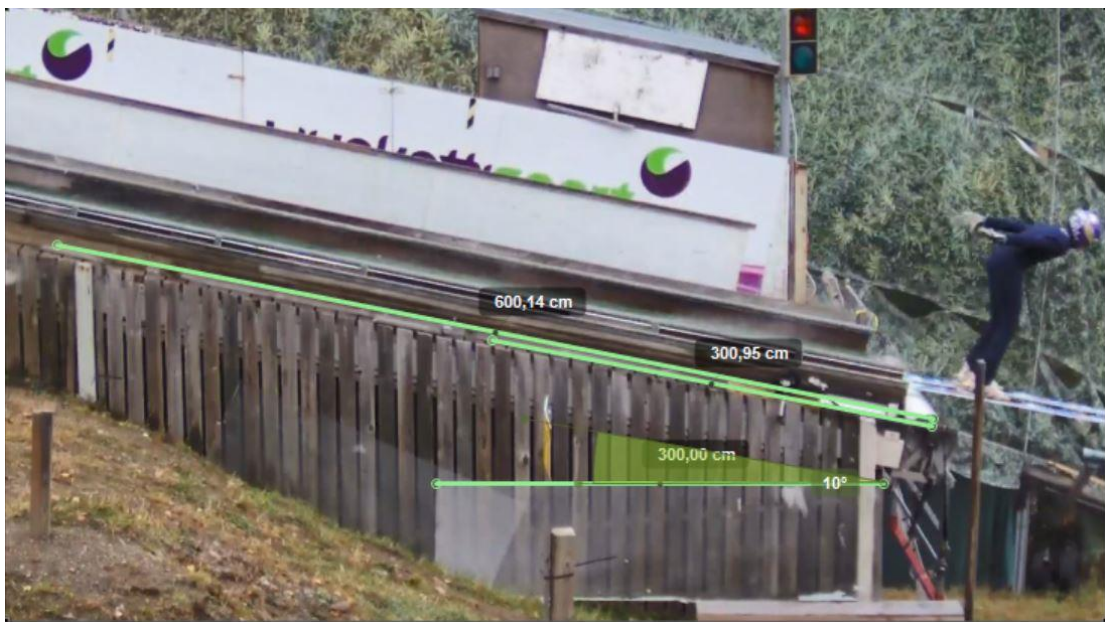
KUVA 21: Mäen kaltevuuden sekä kolmen metrin ja kuuden metrin etäisyyden määrittäminen hyppyrin keulalta. Apuna käytettiin etualalla olevan pleksin pituuden mittaa (3m).
