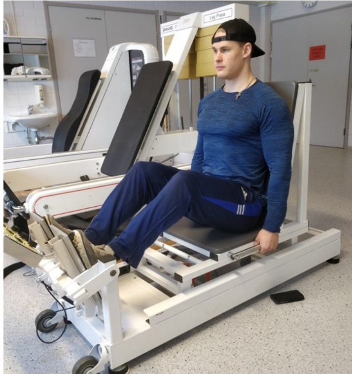
KUVA 5. Isometrinen jalkadynamometri (Jyväskylän yliopiston liikuntalaboratorio, Suomi).
