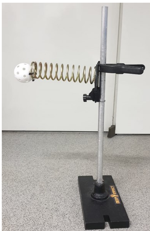
KUVA 3. Polvikulman vakiointiin käytetty laite (Kilpa- ja huippu-urheilun tutkimuskeskus, Jyväskylä, Suomi).
