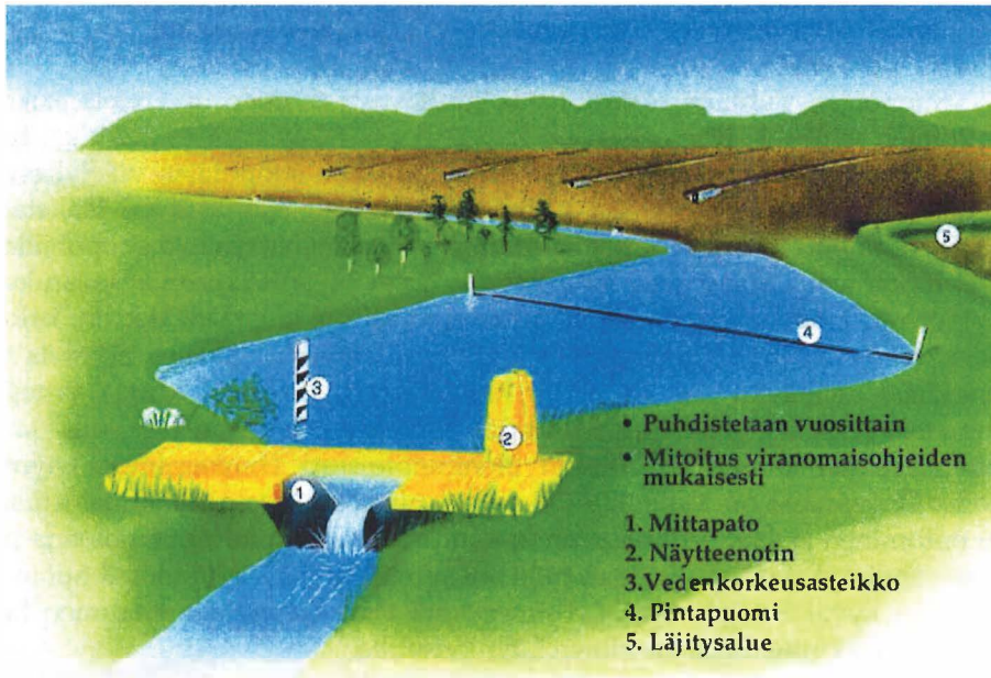
KUVA 24 Turvetyömaan perusvesienkäsittelyyn kuuluu laskeutusallas, joka on maaperään mitoitusohjeiden mukaan kaivettu allas.
