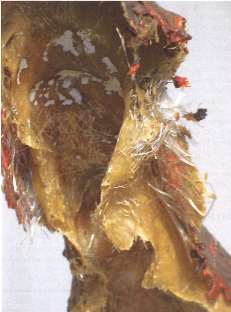
KUVA 24 Kellastunutta UP-komposiittihartsipintaa. Kuva on julkaisusta Two case studies of unsaturated polyester composite art objects, e-Preservation science 2006, 3, 11-19: Knuutinen, U. and Kyllönen, P. Kuva Päivi Kyllönen.
