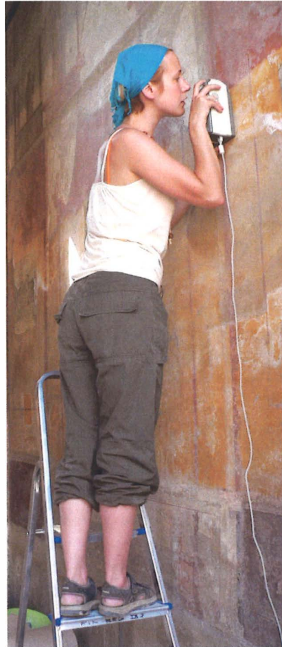
KUVA 5 Non-destructiivista/non-invasive- tutkimusta Pompejissa. VIS (näkyvän valon) in situ -spektrimitausta Minolta 2006d:lla Vesuviuksen purkauksen vaurioittamalta seinäpinnalta. Marcus Lucretiuksen talon huone 8/ ala. Kuva Raija Kaarto.
