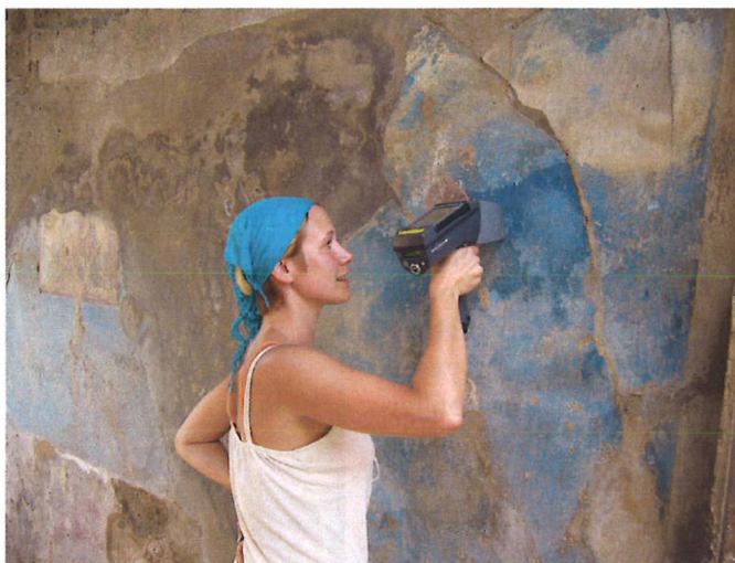
KUVA 6 Non-desruktiivista/non-invasive-tutkimusta Pompejissa. Seinämaalausten pigmenttien in situ XRF (Röntgenfluoresenssi)-alkuaine-analyysijä InnovX®-laitteella. Marcus Lucretiuksen huone 1, prothyrum. Kuva Pasi Kaarto.
