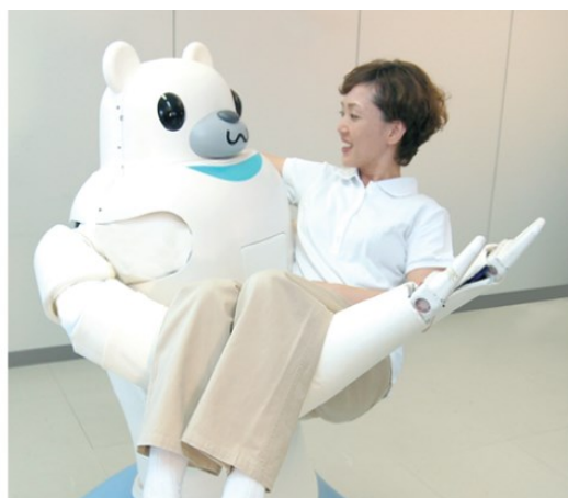
KUVIO 3 RIBA - potilaan nostamisen avuksi tarkoitettu robotti (RIKEN-TRI, 2020)
