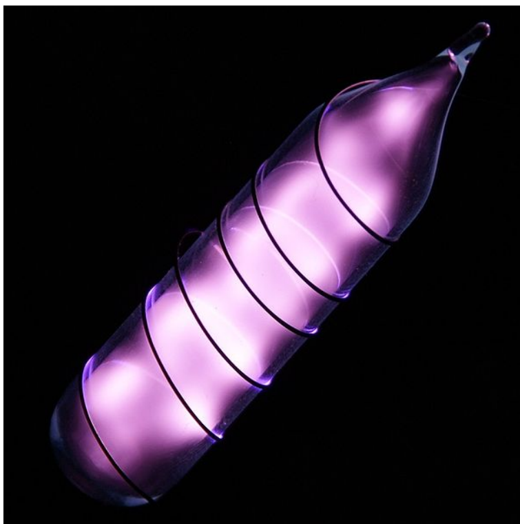
Kuvio 3. Heliumplasmapurkaus. Heliumplasman väri voi vaihdella kuvan magentasta siniseen riippuen plasman paineesta. Kuva lähteestä [17].
