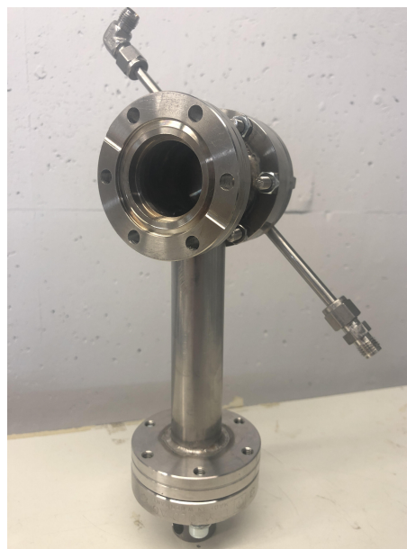
(b) Valokuva varauksenvaihtokanavasta. Toinen päätylaippa on irroitettu.
