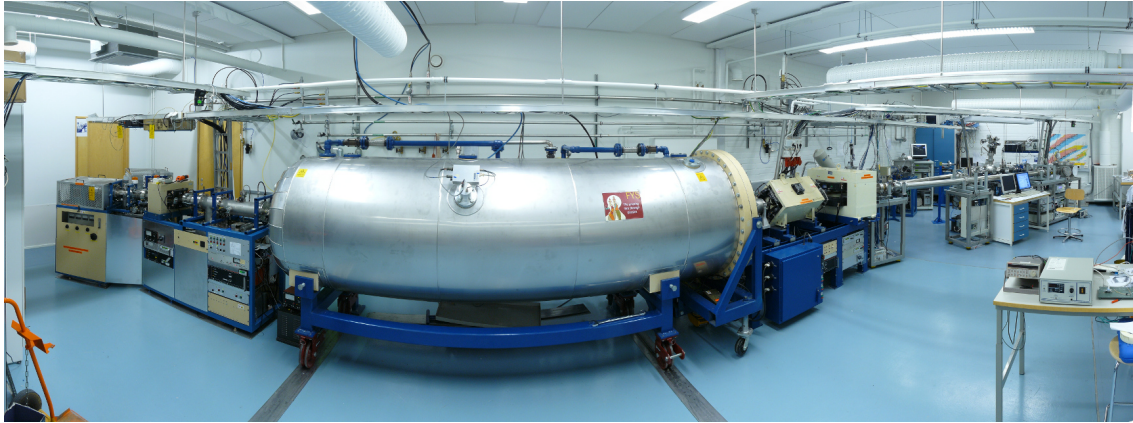
Kuvio 6. Kuva Pelletron-hiukkaskiihdyttimestä Jyväskylän yliopiston kiihdytinlaboratoriossa. Kuvassa vasemmalla sijaitsevat ionilähteet, joiden tuottamia ionisuihkuja keskellä oleva Pelletron-kiihdytin kiihdyttää ja suihku ohjataan oikealla sijaitseviin tutkimusasemiin. Kuva on lähteestä [32]
