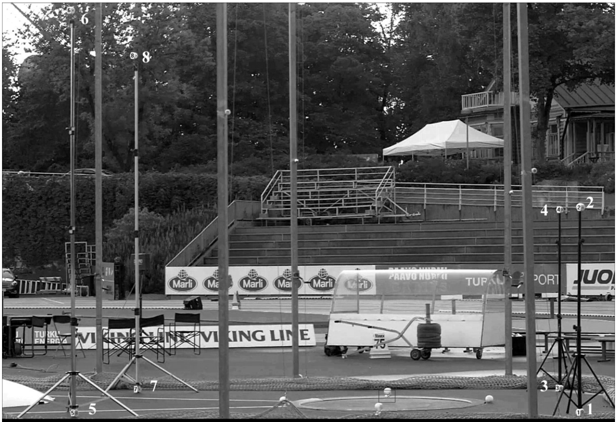
KUVA 14. Kalibrointikehikko Paavo Nurmi Games –kilpailussa (pisteet 1–8). Heittosuunta kuvassa oikealta vasemmalle. Koordinaatiston origo määritettiin kalibrointipisteeseen 1.
