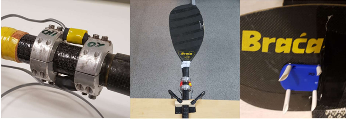
KUVA 1. Anturivarren venymäliuska-anturi (vasen), kalibrointijärjestely (keskellä) ja SmartPaddlen kiinnitys (oikea).
