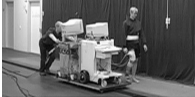
Kuvio 18 Koehenkilö käveli voimalevyanturien ylitse. Ultraäänilaitteistoa liikutettiin koehenkilön rinnalla erityisen kiskojärjestelmä avulla. Voimalevyt erottuvat vaaleammalla värityksellään muusta lattiamateriaalista. Oikealla ylhäällä näkyy valokenno.
