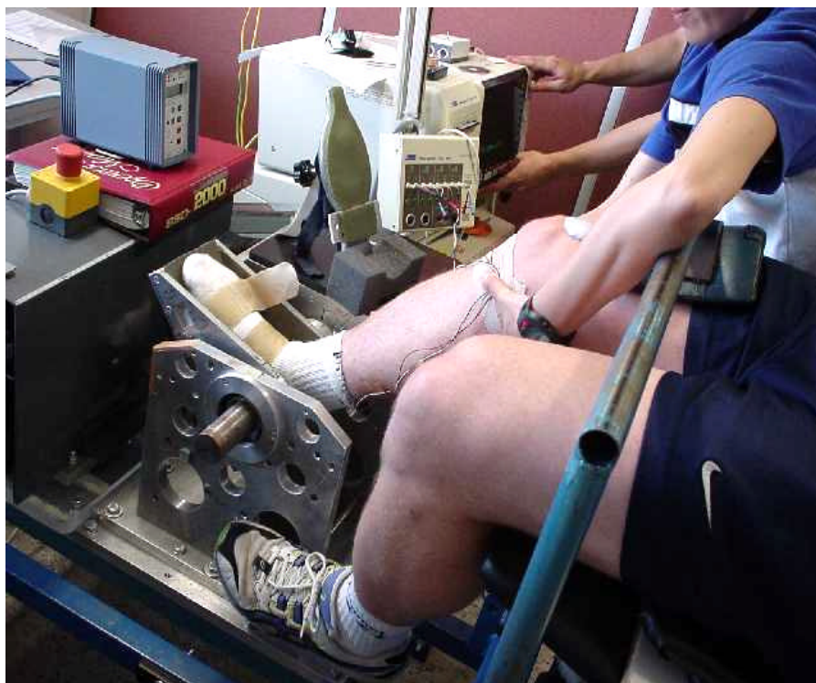
KUVA 16. Nilkkadynamometri, jossa koehenkilön polvi oli ylhäältäpäin tuettu ja jalkaterä pedaaliin sidottu.
