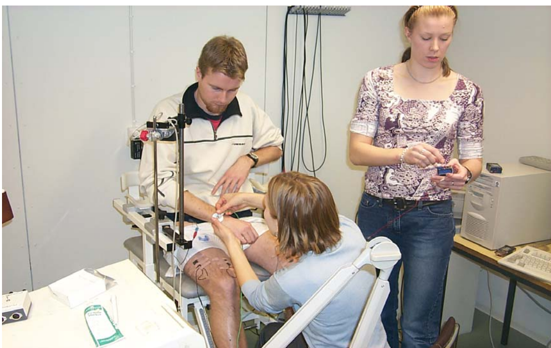
Kuva 16. Koehenkilöä valmistellaan mittauksiin: maaelektrodin kiinnittäminen ranteeseen.
