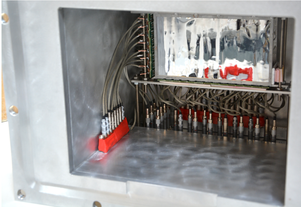
Kuva 11. Ilmaisim metallikehikkoineen MARA:n fokustason tyhjiökammion ha-tussa. Kytkentälevyt, joissa SiPM:ien bias-jännitteenjaot tehdään, on ympäröity punaisella teipillä niiden eristämiseksi sähköisesti metallihatusta. Kytkentälevyi-hin tehtiin myös yhdet ylimääräiset paikat kaapeleille rikkoutumisen varalta.
