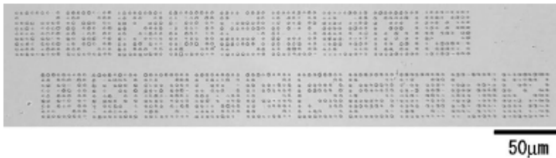
Kuva 6: 19 eri hologrammin avulla valmistettu laserkirjoitus lasinäytteellä. Kuva on 20-kertaisen suurennoksen läpäisyelektronimikroskooppikuva. Kuva on otettu lähteestä (27). Kuvan käyttöön on saatu julkaisijan (AIP Publishing) lupa.
