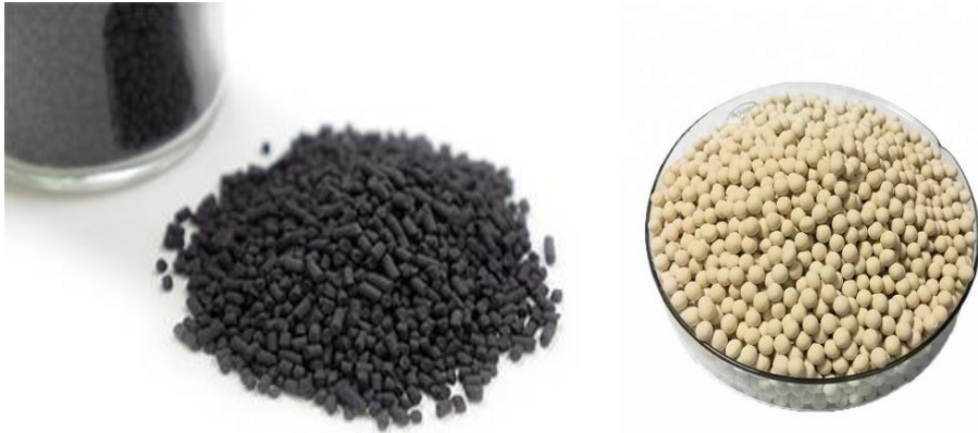
Kuva 16: Aktiivihiilipellettejä (vasen) 122 ja zeoliittirakeita (oikea) 123 .
