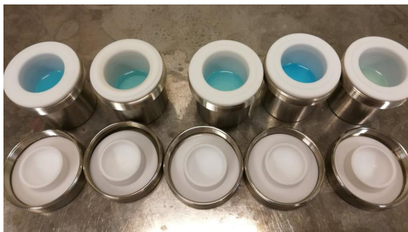
Kuva 36: Solvotermisten reaktioiden näytteitä pienoisautoklaaveissa.
