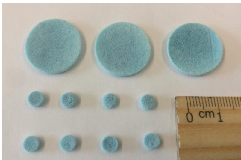
Kuva 24: HKUST-1-jauheesta ja polypropyleenista valmistetut 3D-tulosteet jauheröntgendiffraktiomittauksia ja CO 2 -adsorptiokokeita varten.
