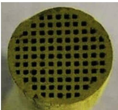
Kuva 18: Pursottamalla valmistettu MOF/bentoniittimonoliitti. Kanavien halkaisijat monoliitissa olivat 0,9 mm. 94
