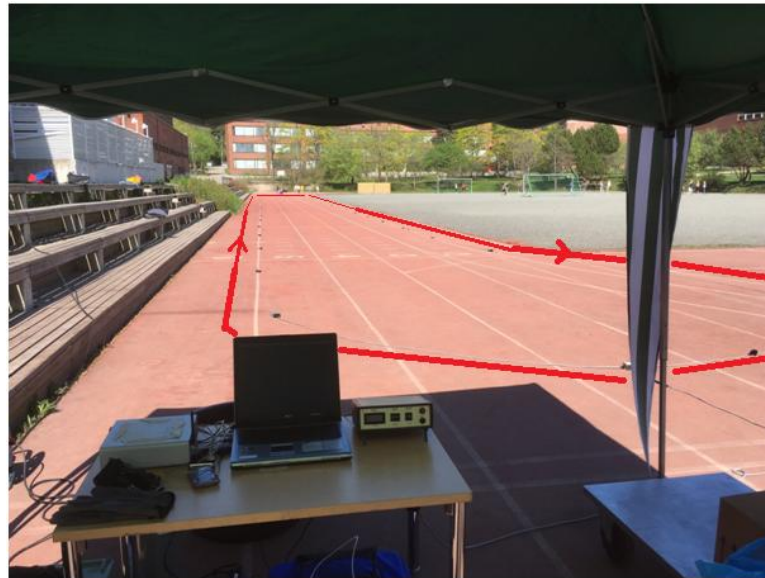
KUVA 16. Kenttämittausten laitteistoa. Kuvassa on nähtävissä valojäniksen ohjausyksikkö, kentälle levitetty valojäniksen 200 metrinen valorata, hengityskaasuanalysaattorin kannettava tietokone ja vastaanotinyksikkö. Etenemissuunta radalla tapahtui myötätäpäivää.
