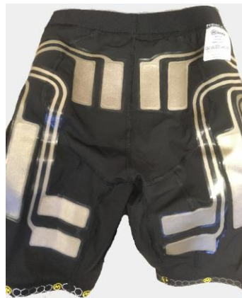
KUVA 20. Kuvassa on esitettyä nurinpäin käännetty shortsit takaapäin kuvattuna ja kuvassa on nähtävissä pakaroiden-, takareisien- ja maadoituselektrodien sijoittelut.
