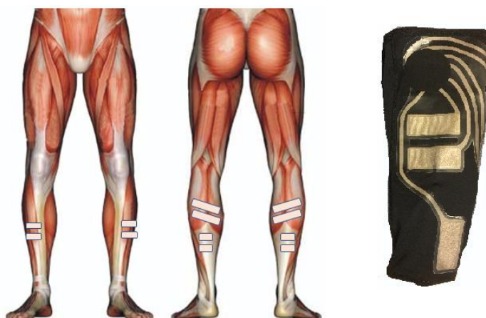
KUVA 21. Piirros 3-kanavaisten EMG-säätimien kangaselektrodien sijainneista, sekä oikealla kuva kangaselektrodeista (Tolvanen P., henkilökohtainen tiedonanto, 19.3.2019).
