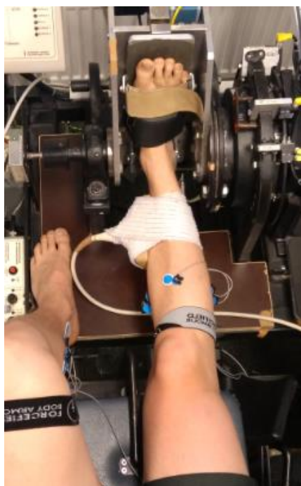
Kuva 18. Oikea jalka nilkkaergometrissa ja Alokalan ultraäänilaitteen leveä pää asennettuna.
